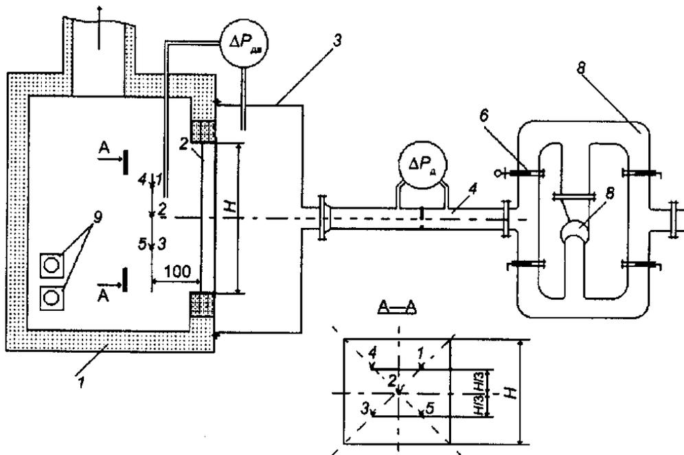
1 - печь; 2 - испытываемый образец двери; 3 - пневмокамера; 4 - стенд определения расходных характеристик инженерного оборудования; 6 - регулирующая заслонка; 7 - воздуховоды обвязки стенда; 8 - вентилятор; 9 - форсунки;
